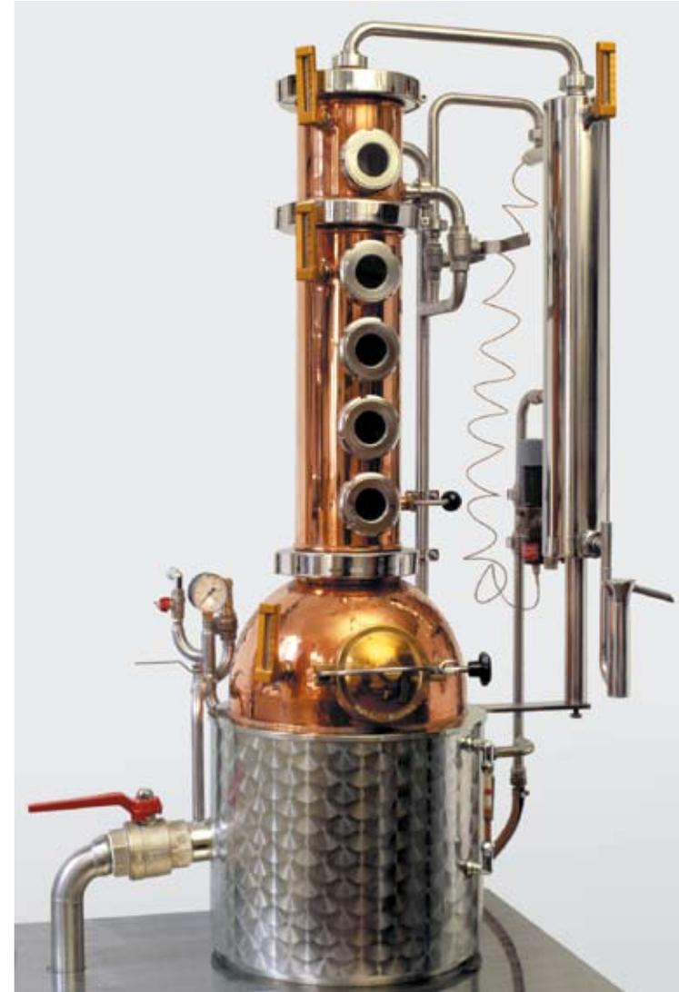
Destillierapparat zur fraktionierten Destillation.
